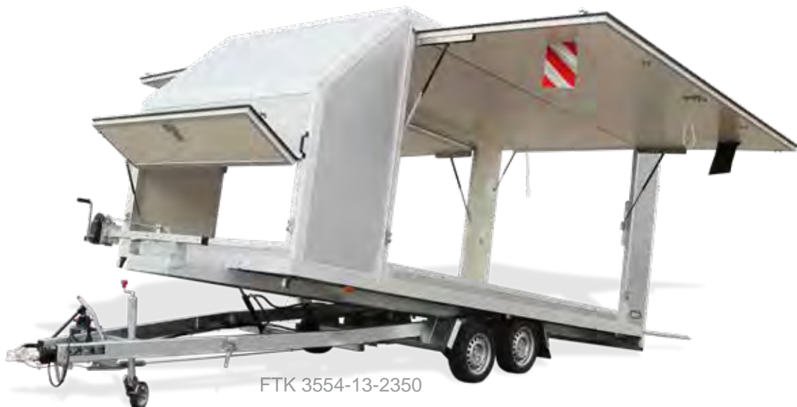
Ladefläche kippt durch Schwerpunktverlagerung oder hydraulisch für eine schnelle Beladung
