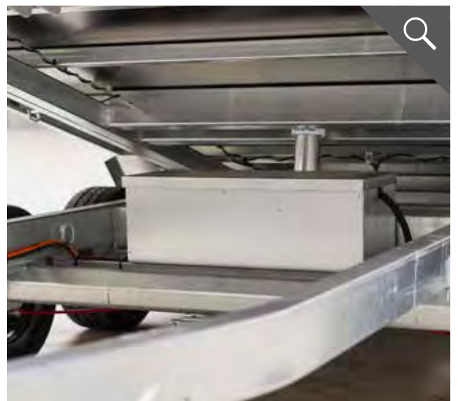
Elektrohydraulik mit Funkfernbedienung inkl. Batterie und Ladegerät
