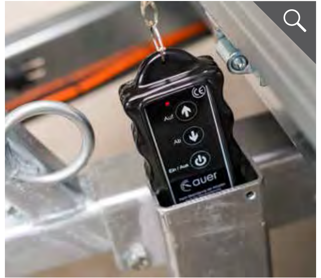
Funkfernbedienung für einfaches Kippen
