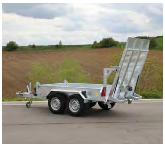
Sonderbau: Typ UBA mit schräger Auffahrrampe
