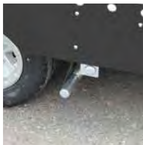
Einfache Entriegelung der Auffahrschienen durch Quickstop-Fußbetätigung
