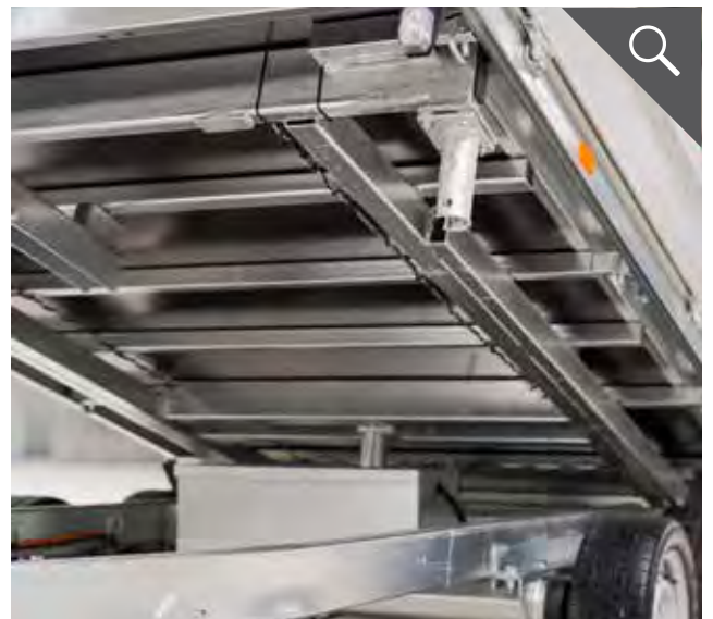
Verschweißter und feuerverzinkter Stahlrahmen
