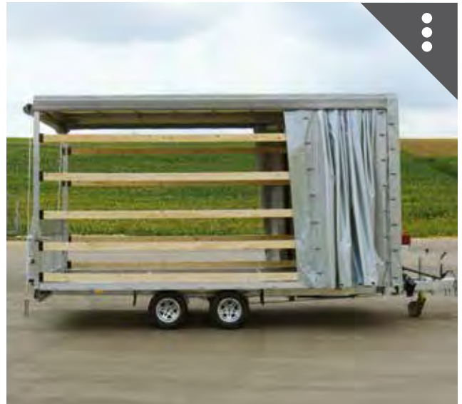
Plane und Gestell mit Schiebeplane für wettergeschützten Transport und seitlicher Be- und Entladungsmöglichkeit
