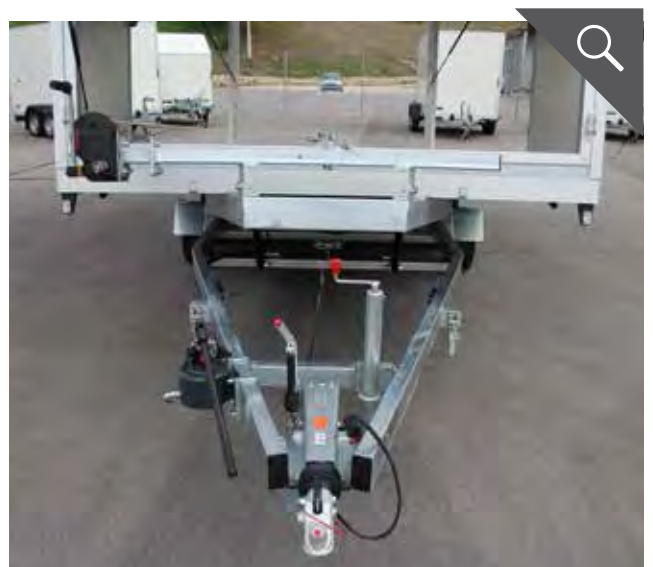
Fahrgestell aus verschweißter und feuerverzinkter Hohlprofilkonstruktion
