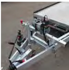
Verschweißter und feuerverzinkter Stahlrahmen
