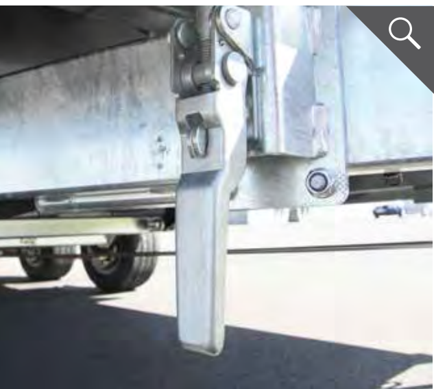
Sicherungsverchluss der Abkippfunktion
