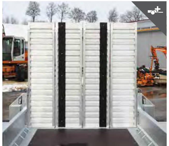
Gummiauflage für das Befahren mit Kettenfahrzeugen
