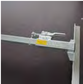
Integriertes Zurrsystem für einfache Ladungssicherung
