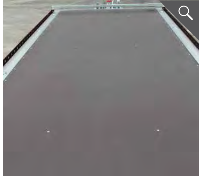
Durchgehende Bodenplatte ohne Stoß (18 mm)
