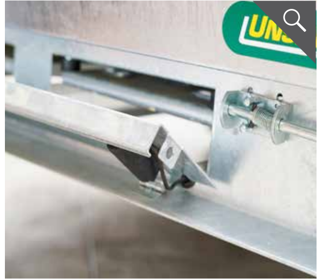
Abklappbarer Kennzeichenhalter zum eleganten Verstauen der Auffahrschienen
