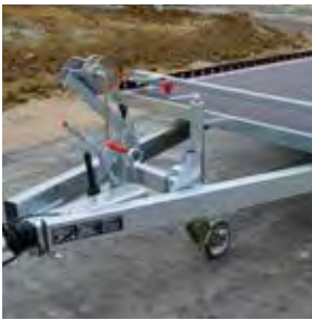
Rahmen aus geschweißtem Hohlrahmenprofil
