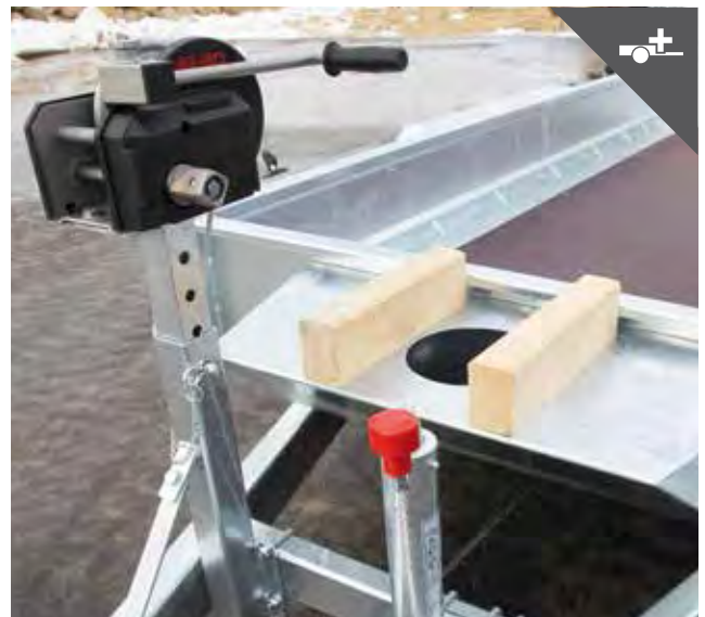
Baggerarmauflage, Windenbock mit Handseilwinde
