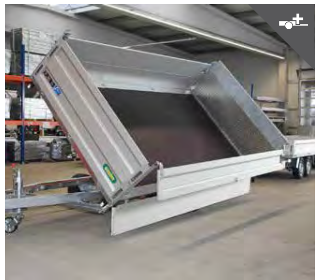
Bordwandaufsatz für mehr Ladevolumen
