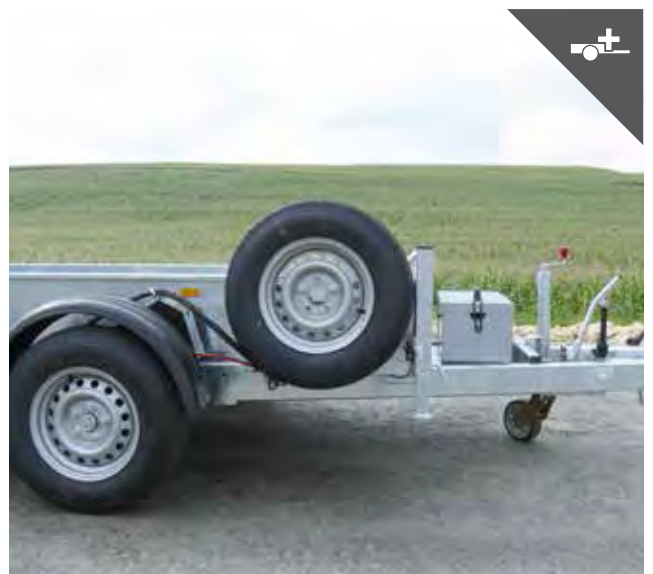
Ersatzradhalter für Bordwandmontage
