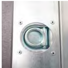
8 Zurrmulden versenkt im Bodenrahmenprofil, Dekra zertifiziert
