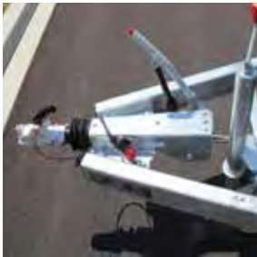
Rahmen aus geschweißtem Hohlprofil
