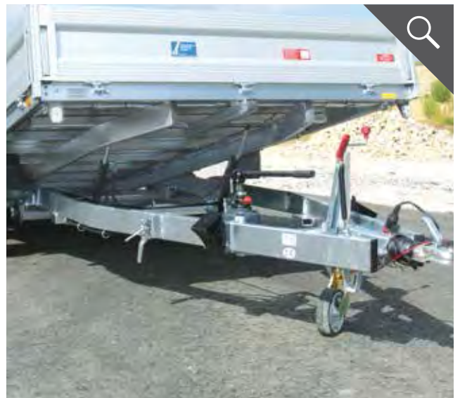
Verschweißter und feuerverzinkter Stahlrahmen
