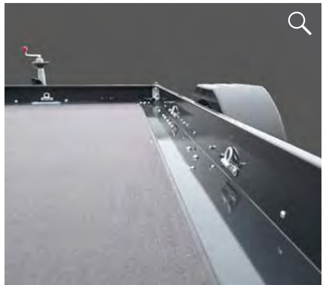
Rutschhemmende und wasserfeste Ladefläche aus mehrfach verleimter Siebdruckplatte (18 mm)
