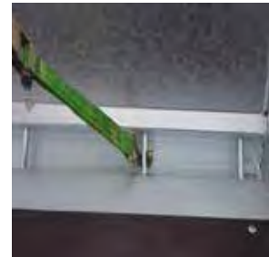
Zurrpunkte bis zu 2.000 kg belastbar
