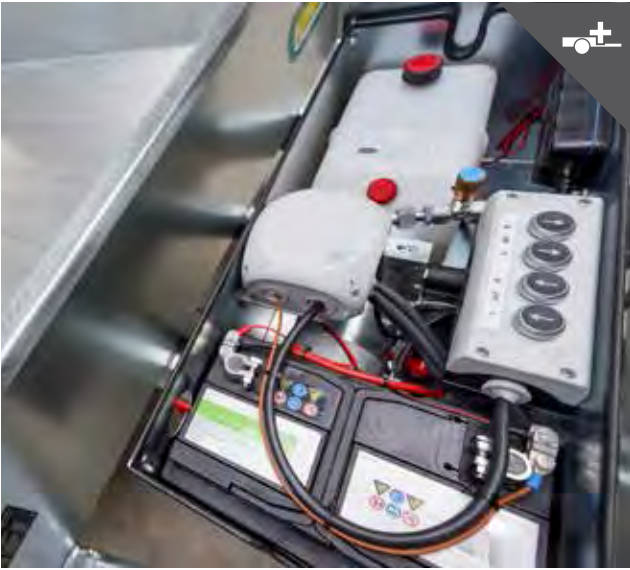
Leistungsstarke Elektrohydraulik wasser- und schmutzgeschützt
