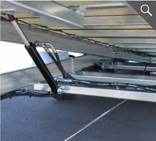
Doppeltwirkende Hydraulikzylinder für sicheres Beladen
