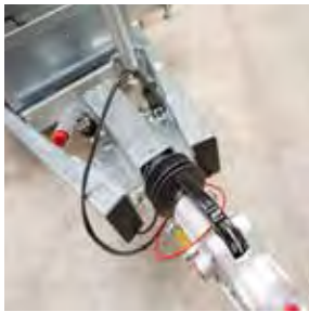
Rahmen aus geschweißtem Hohlprofil für Stabilität
