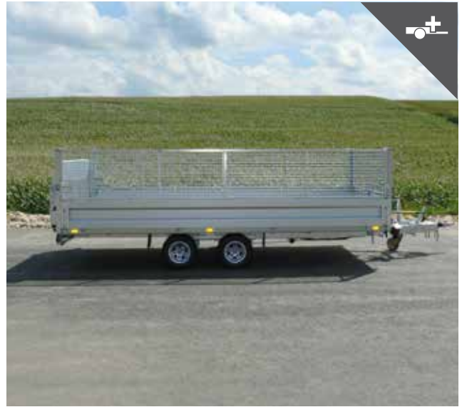
Welldrahtgitteraufsatz für mehr Ladevolumen
