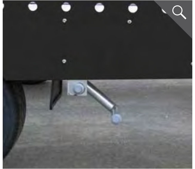
Quickstop-Fußbetätigung zum Entriegeln der Auffahrschienen
