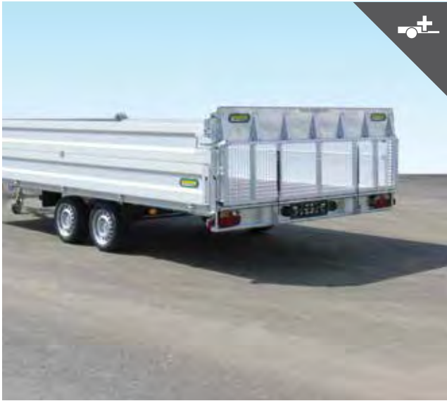
Bordwandaufsatz für mehr Ladevolumen z. B. von Schüttgut
