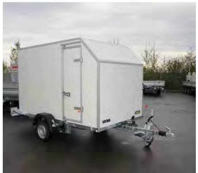
Sonderbau: Typ ASK mit Tür und Dachfenster
