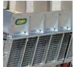
Durchgehende Stahlgitterauffahrklappe mit Alu-Riffelblech belegt
