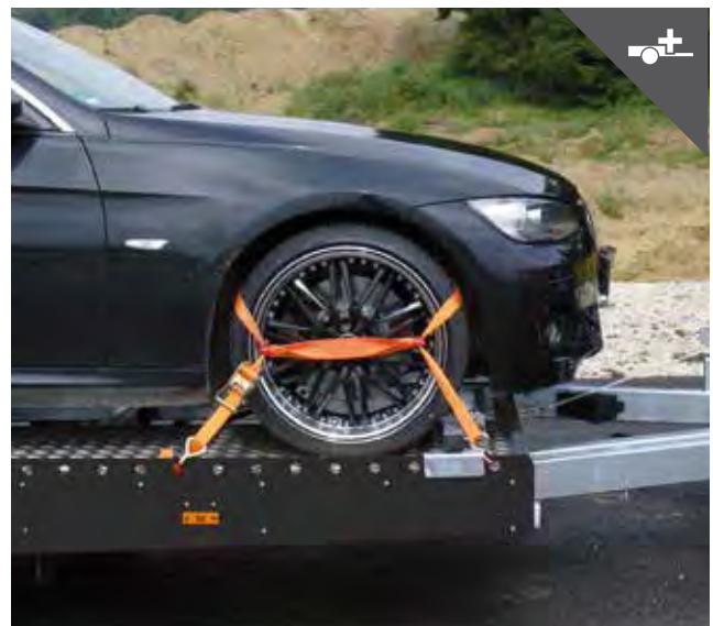
Flexible Verzurrmöglichkeiten der Radsicherungsgurte
