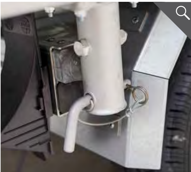
Umsteckbolzen für die Kippfunktion
