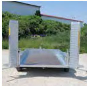
Auffahrrampen seitlich schwenkbar
